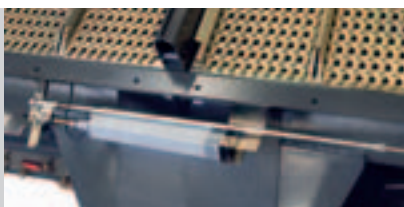
Réglage électrique des grilles
