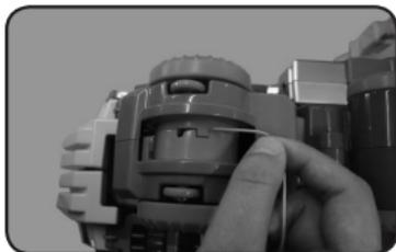
3. Déplacer la ficelle sur le côté pour que le nœud ne puisse pas se déplacer vers le trou.
