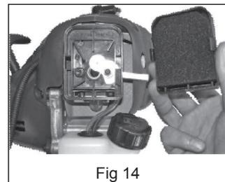
**AVERTISSEMENT** : Ne nettoyez jamais le filtre en mousse dans un bain d'essence, de White spirit ou tout autre diluant, ces produits détériorent la mousse filtrante. Si l'élément filtrant est endommagé ou très sale, remplacez-le.
