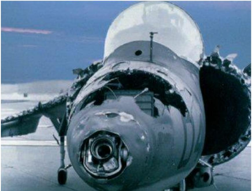
Figure 39 Avion endommagé par la grêle
