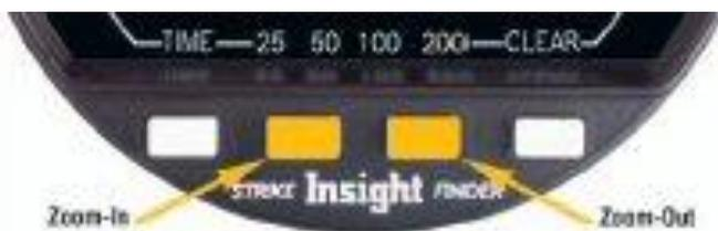
Figure 6 : Commande de changement d'échelle
