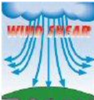
L'effet du cisaillement du vent peut être dévastateur pour un avion, particulièrement lors des basses altitudes, comme lors des décollages et atterrissages. Pendant ces phases de vol, les performances de l'avion sont sévèrement dégradées derrière ses capacités de compensation.
