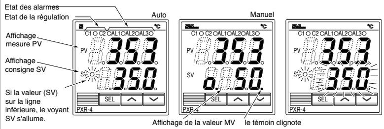
Si aucun réglage n'est effectué pendant 30 secondes, l'affichage se réinitialise aux valeurs PV/SV affichées à la mise sous tension de l'appareil
