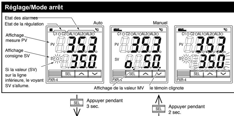
· Si aucun réglage n'est effectué pendant 30 secondes, l'affichage se réinitialise aux valeurs PV/SV affichées à la mise sous tension de l'appareil
