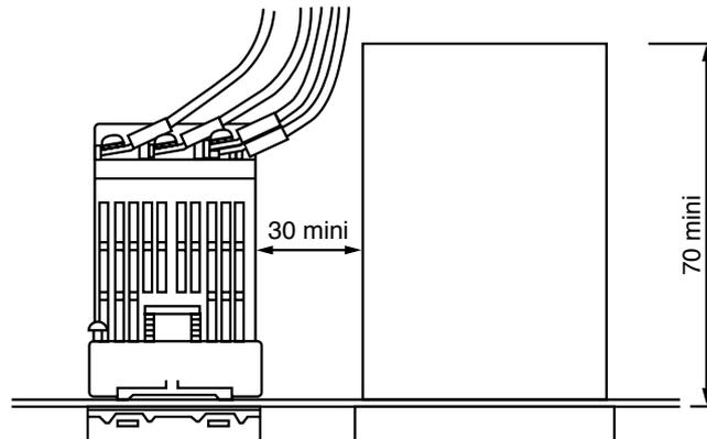
Si un autre appareil (profondeur > 70mm) est monté à proximité ou si le régulateur est placé à coté d'une cloison, respecter un intervalle de 30 mm entre les différents appareils ou entre le régulateur et cette cloison.
