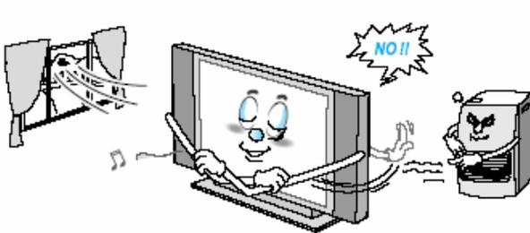
L'écran doit être bien ventilé. Il y a des fentes dans le boîtier prévues pour la ventilation afin d'empêcher l'appareil de surchauffer. N'obstruez pas ces fentes avec un objet et ne placez pas l'écran sur un lit, fauteuil, tapis ou toute surface similaire. Ne le placez pas près d'un radiateur ou source de chaleur. Si vous placez l'écran sur un casier ou une bibliothèque, assurez vous qu'il y a suffisamment de ventilation et que vous avez suivi les instructions du fabricant pour le montage.
