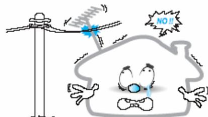
La distance entre l'antenne extérieure et les lignes électriques doit être suffisante pour éviter tout choc électrique ou tout contact entre elles même si l'antenne tombe.
