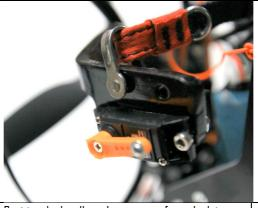
Position de décollage: La suspente frontale doit être tirée de 5 à 10mm
