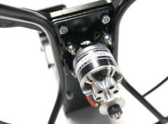
Procédez ensuite au montage de votre hélice (notez que nous préconisons d'utiliser une taille d'hélice n'excédant pas 10 pouces. Au delà, l'arceau de protection ne pourra plus jouer son rôle). N'oubliez pas de vérifier le bon sens de montage de l'hélice et de rotation du moteur. Le bord d'attaque de l'hélice doit toujours être orienté vers l'avant du Backpack.
