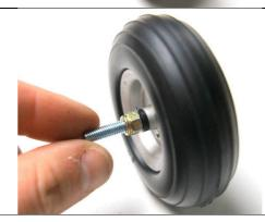
Fixez ensuite l'axe sur le train d'atterrissage arrière à l'aide un d'autre écrou frein M5. Faire de même pour l'autre roue, comme sur la photo.
