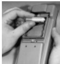
Dégagez les piles usées en veillant à ne pas les mélanger avec les neuves et remettez les quatre piles neuves après avoir vérifié qu'aucune oxydation ne s'est formée sur les contacts des piles.
