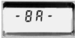
Lorsque l'instrument indique un message BA , il va s'éteindre d'un moment à l'autre et les piles doivent être immédiatement remplacées.
