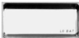
Lorsqu'une indication LO BAT apparaît sur l'afficheur, il reste une autonomie d'une cinquantaine de mesures.
