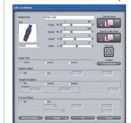
On peut stocker différentes conditions de découpe. Une fois stockées, il suffit de sélectionner la condition optimale dans le tableau.
