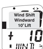
Am Wind werden Richtungsänderungen durch eine festgesetzte Skala von +/- 25 Grad um Zentralnull angezeigt. Jedes Segment des Diagramms entspricht einer Änderung von 2.5 Grad.
