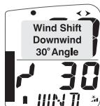
Con viento de popa, el gráfico indica el ángulo entre el rumbo y la dirección media del viento (MWD) siendo cero la parte baja del gráfico. Cada segmento del gráfico corresponde a 2.5 grados de rolada.
