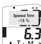
Snelheidsveranderingen worden standaard weergegeven op een schaal die +/- 25% aangeeft ten opzichte van een centrale '0'. De schaal kan in de instellingen gezet worden op +/- 25% of +/- 100%.
