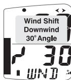
Vor dem Wind zeigt das Diagramm den Winkel zwischen Kurs und der mittleren Windrichtung (MWD), ausgehend von Null am unteren Ende des Diagramms, an. Jedes Segment des Diagramms entspricht einer Änderung von 2.5 Grad.
