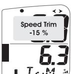
La regolazione della velocità viene indicata usando una scala di percentuale corrispondente a +/- 25 percento sullo zero centrale. Eventualmente la scala può essere impostata da +/- 25 e +/- 100 percento nel setup.
