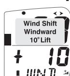
En ceñida, los Desplazamiento del Viento son indicados usando una escala de +/- 25 grados sobre cero. Cada segmento del gráfico de barras corresponde a 2.5 grados de rolada.
