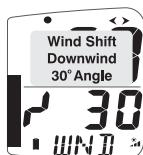
Au portant le curseur graphique indique l'angle de descente par rapport à la direction moyenne du vent (MWD) à partir d'un zéro en bas du graphe. Chaque graduation correspond à un angle de 2.5 degrés.
