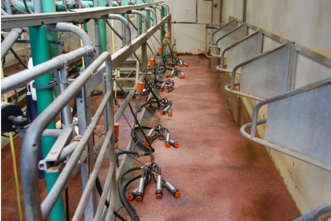
Salle de traite prête pour un contrôle 'à sec'
