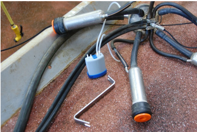
VaDia connecté au tuyaux court de pulsation
