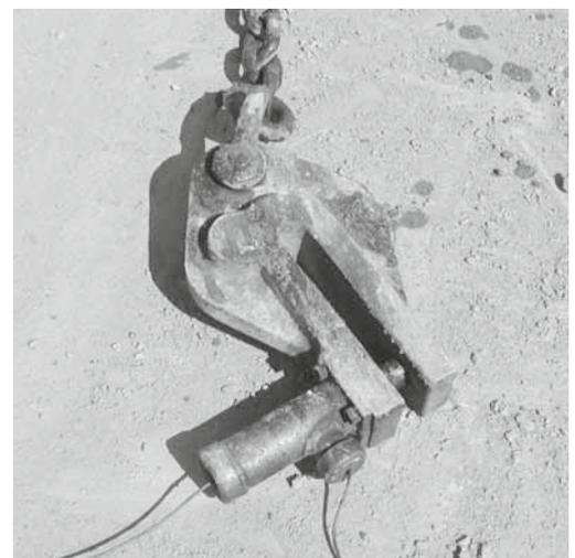
Fig. 2: des maillons de sécurité garantissent un accrochage et un décrochage sûrs des tubes de forage, palplanches, etc.
