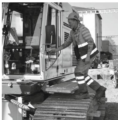
Fig. 4: savoir monter et descendre correctement des engins de chantier permet d'éviter de nombreux accidents.
