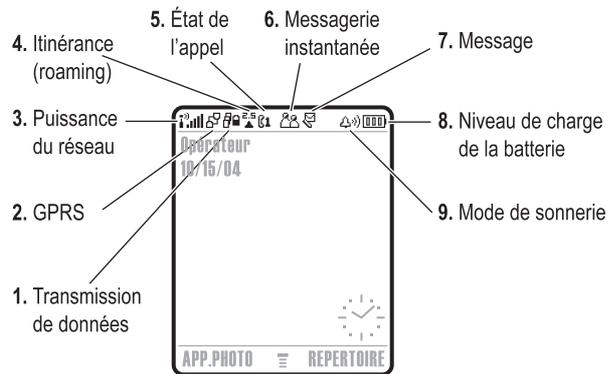
**1. Indicateur de transfert de données** - Indique la connexion et l'état du transfert des données. L'indicateur de connexion sans fil Bluetooth® à signale quand une connexion Bluetooth est active. Voici les autres indicateurs pouvant s'afficher :
