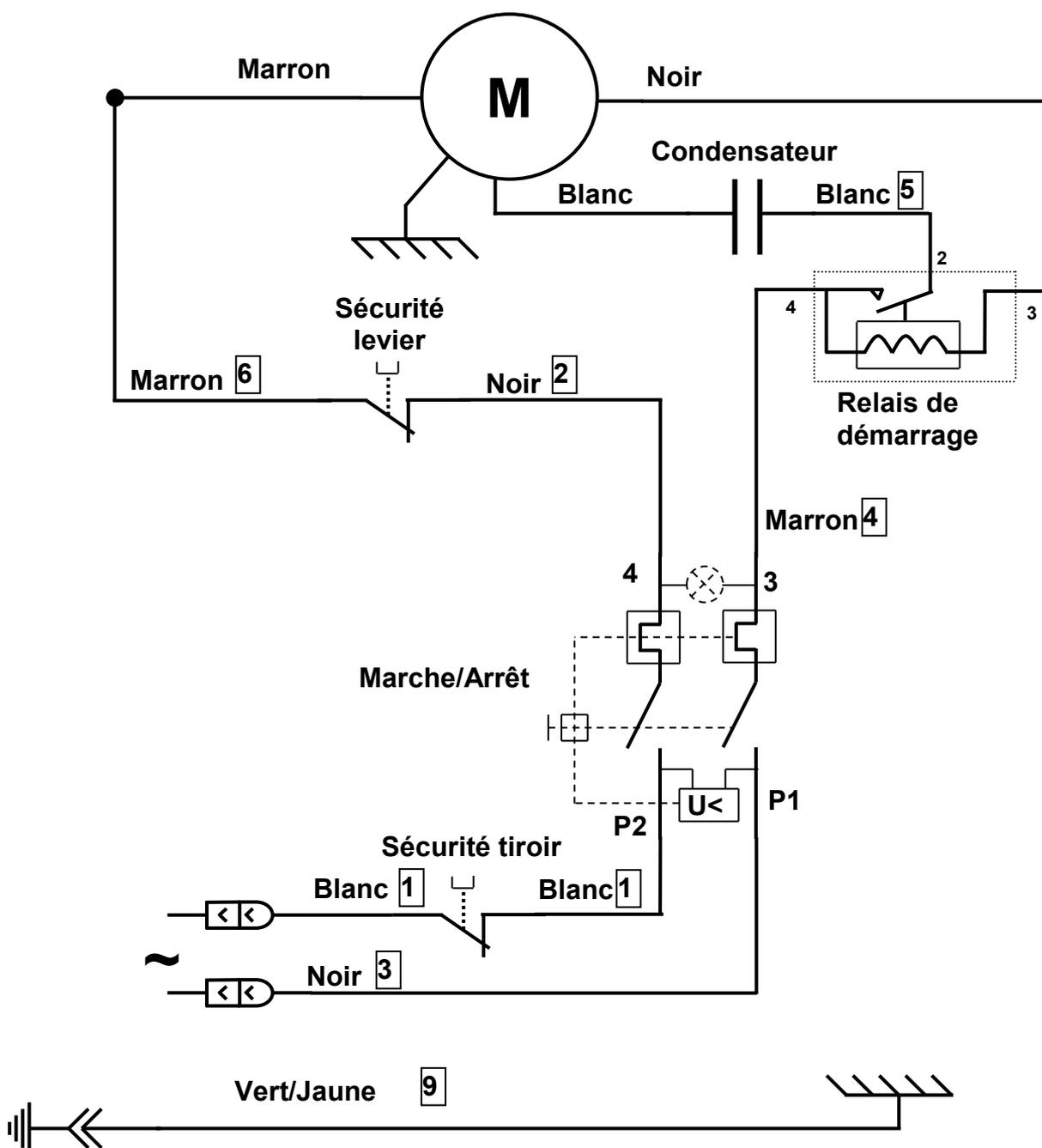
Schéma électrique 100-120V 50/60Hz
