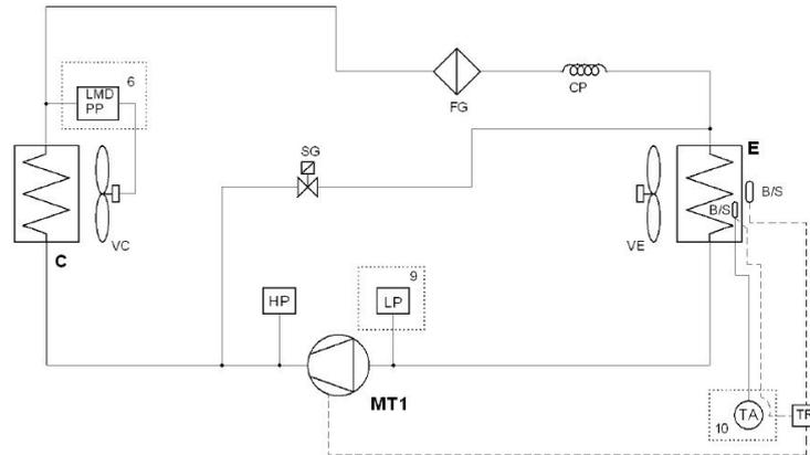
El compresor (MT1) comprime al gas refrigerante, llevándolo a una alta presión y temperatura;
