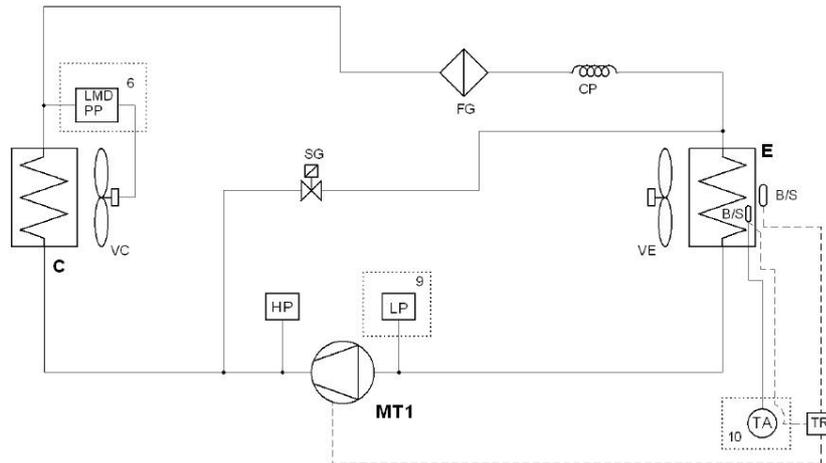
Il compressore (MT1) comprime il gas frigorifero, portandolo ad una alta pressione e temperatura;
