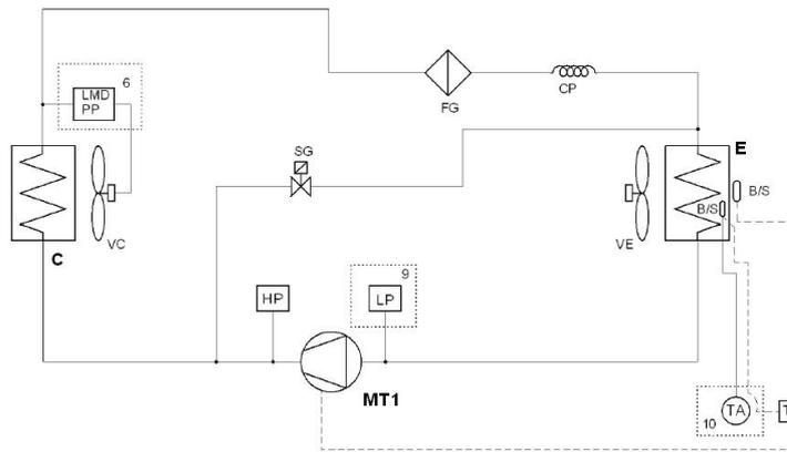
Le compresseur (MT1) comprime le gaz frigorigène et le met sous haute pression et haute température ;
