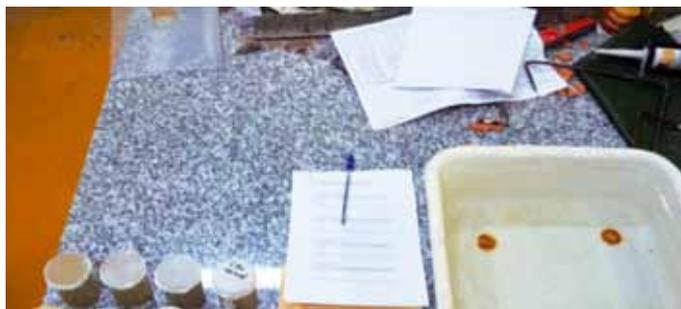
Dispositif de mesure d'absorption d'eau sous basse pression : quantité d'eau susceptible de pénétrer dans le support par la surface traitée en fonction du temps.
