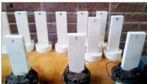
Dispositif de l'essai de Venuat.
