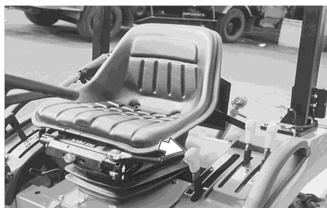
Schéma 23 – Sélecteur hydrostatique de vitesse
