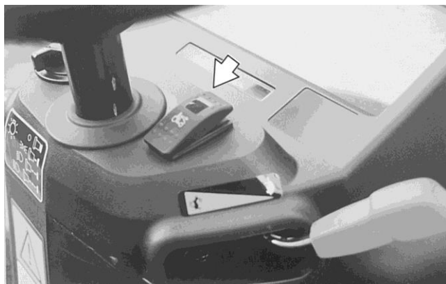
Schéma 24 – Commande hydrostatique de vitesse de croisière
