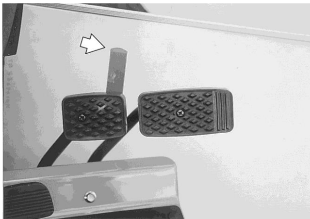
Schéma 15 – Blocage des pédales de frein
