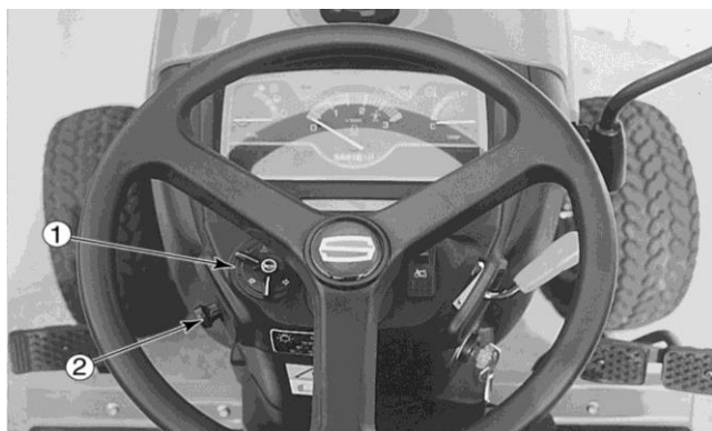
Schéma 8 1. Interrupteur multiple - 2. Interrupteur principal d'éclairage
