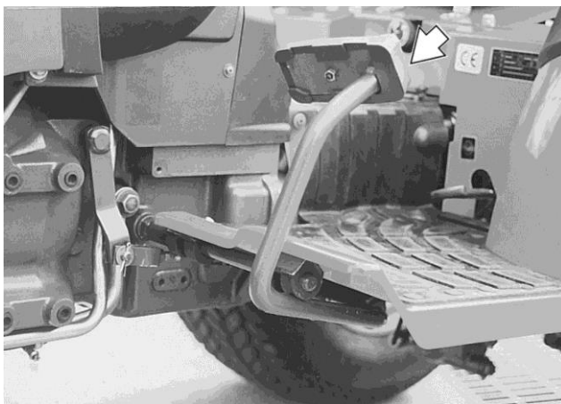
Schéma 25 – Commande d'embrayage
