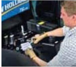
Le contrôle du niveau d'huile moteur et les orifices de remplissage sont faciles d'accès, sans nécessité de soulever le capot. Vous apprécierez également la périodicité de vidange de 600 heures.
