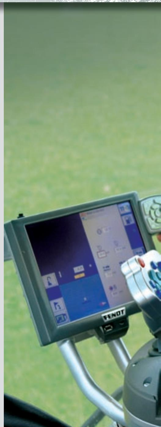
**Vous avez le choix entre le terminal Vario 7" ou 10.4", en fonction de vos besoins spécifiques. Les deux terminaux offrent des commandes de tracteur et d'outil faciles d'utilisation ainsi que la gestion des manœuvres en bout de champ Variotronic TI. Le grand terminal vous permet également d'utiliser le système de guidage automatique VarioGuide présentant un affichage clair du guidage, le système de documentation VarioDoc et des images de caméras externes.**
