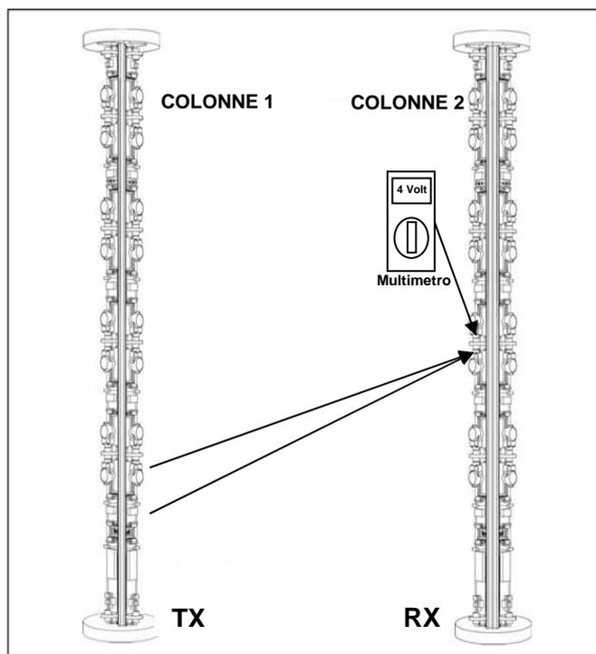
5. Replacer le Cavalier TEST en mode OFF de la première **carte expansion TX** en bas et répéter la procédure d'alignement depuis le point 3 pour toutes les autres **cartes d'expansion TX**.
