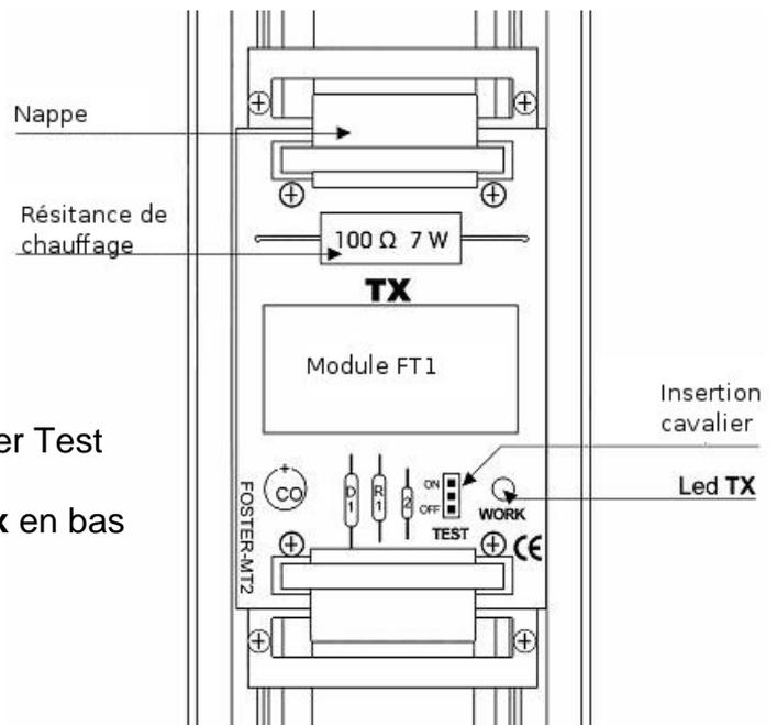
3. Placer le cavalier Test sur la 1<sup>ère</sup> carte d'expansion **Tx** en bas en position **ON**
