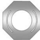
Le bouchon du réservoir de liquide d'embrayage/frein est doté de ce symbole. Le réservoir général de liquide de frein/d'embrayage est rempli de liquide de frein DOT 3, comme indiqué sur le bouchon du réservoir.
