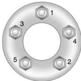
13. Serrer les écrous de roue fermement en croix, selon le schéma.
