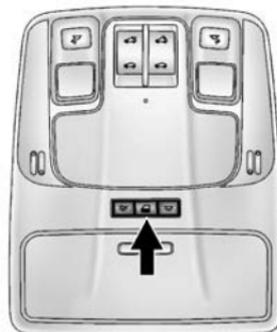
La commande d'éclairage d'habitacle, située dans la console de pavillon, commande les lampes d'habitacle avant et arrière.
