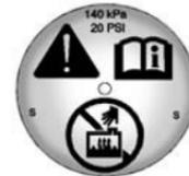
Le bouchon de pression du vase d'expansion de liquide de refroidissement peut être retiré lorsque le système de refroidissement, y compris le bouchon de pression du vase d'expansion de liquide de
