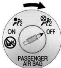
Pour désactiver le sac gonflable frontal de passager avant extérieur, introduire une clé ou une pièce dans le commutateur, l'enfoncer et tourner le commutateur en position off (arrêt).
