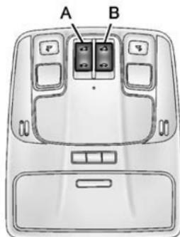
**Ouvrir/fermer:** Maintenir enfoncé l'avant ou l'arrière du commutateur (A) pour ouvrir ou fermer le toit ouvrant. Le pare-soleil s'ouvre automatiquement avec le toit ouvrant, mais il doit être fermé manuellement.
