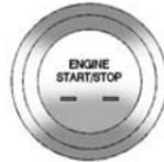
Le véhicule est équipé d'un bouton-poussoir de démarrage électronique sans clé.
