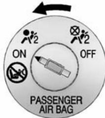
Pour réactiver le sac gonflable frontal de passager avant extérieur, introduire une clé ou une pièce dans le commutateur, l'enfoncer et tourner le commutateur en position de marche.
