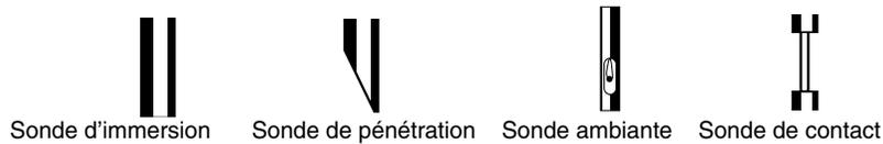
Figure 5: Diverses conceptions de sondes pour la mesure de température
