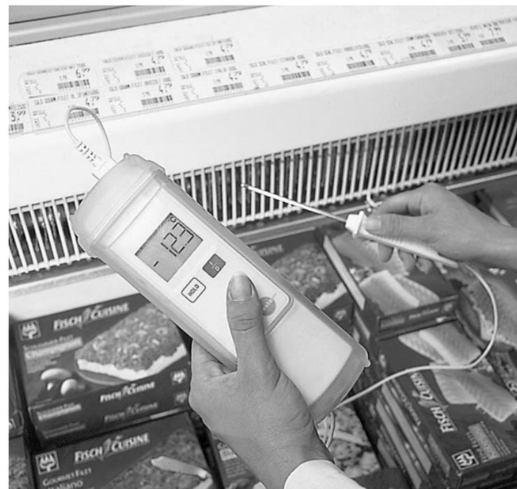
En cas de dépassement d'une valeur de mesure pré-réglée (sur le PC) un signal acoustique résonne ou un témoin lumineux se met à clignoter. Ceci rend possible une surveillance idéale de locaux réfrigérés, de congélateurs, de surgélateurs, ...
