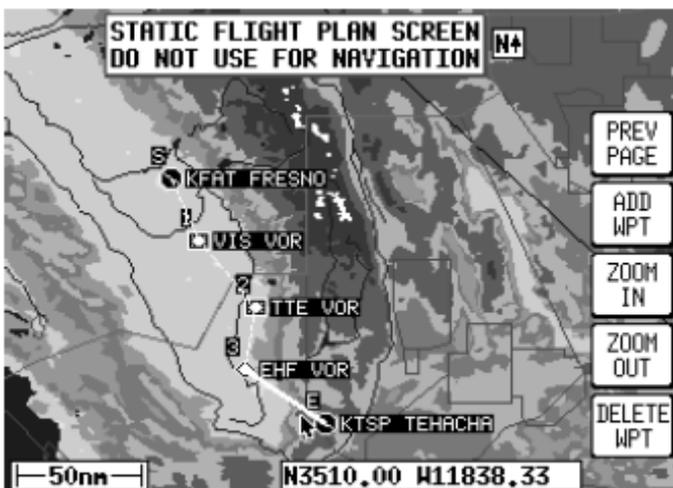
Figure 13 : Créer et modifier un plan de vol visuellement
