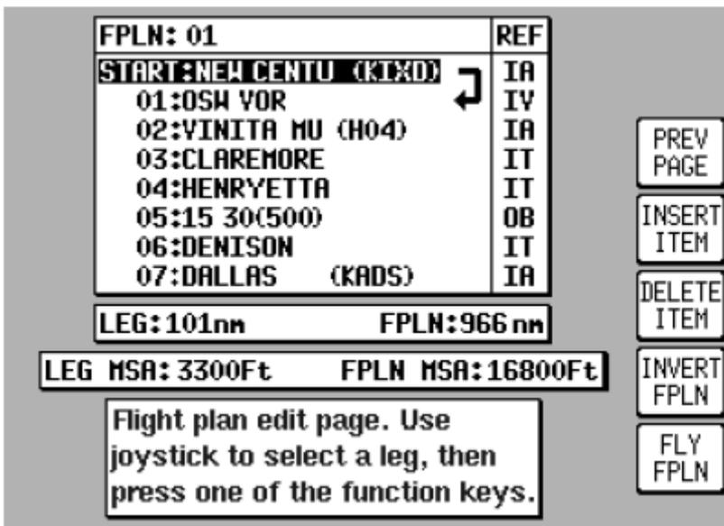
Figure 12 : Créer et modifier un plan de vol manuellement
