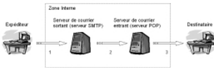
figure 2 : Processus de transfert d'un courrier électronique
