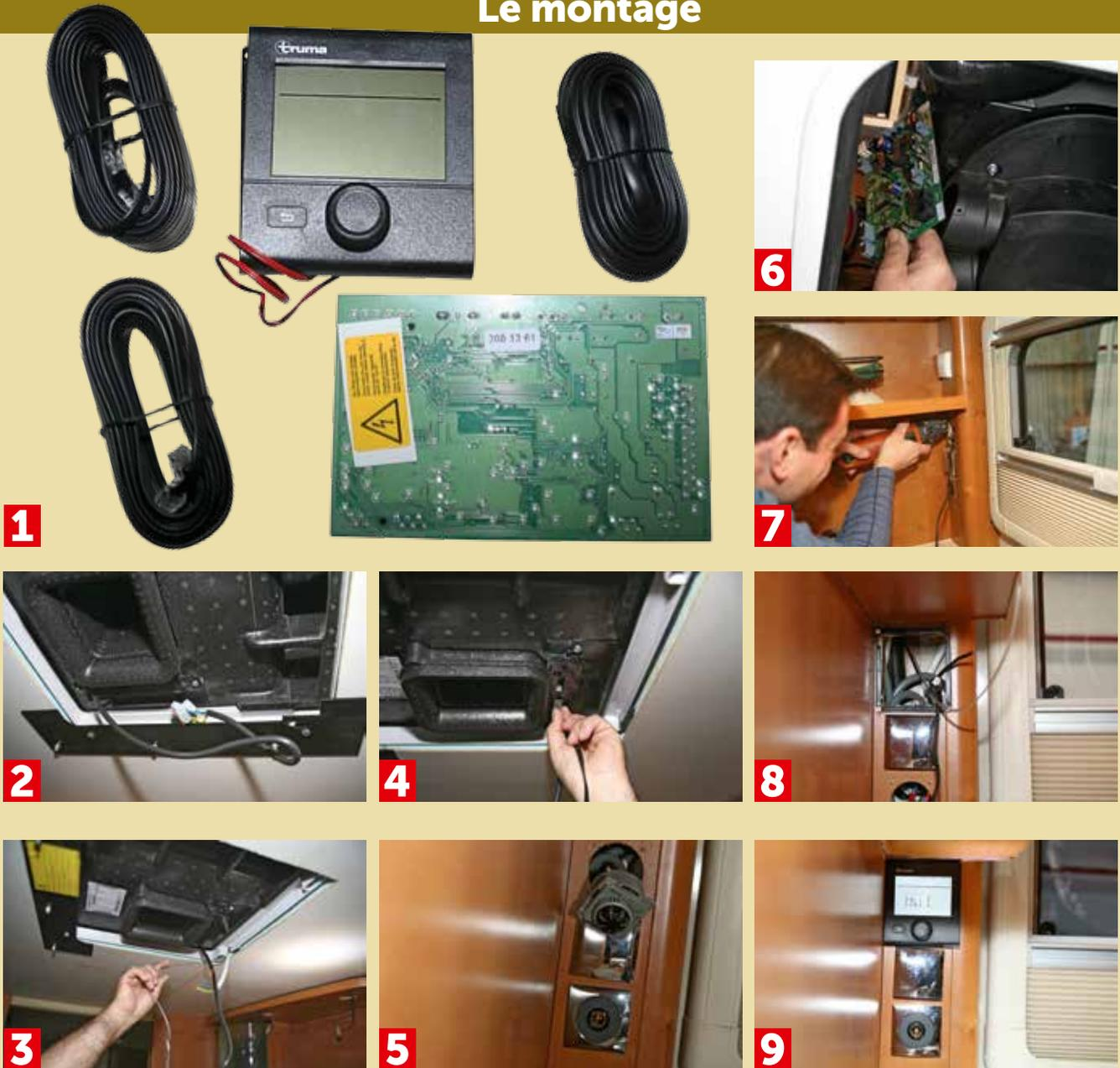
Nous avons choisi de poser une commande CP Plus sur un camping-car doté d'un Combi non compatible et d'un climatiseur Aventa de Truma. Cela afin de vous montrer toutes les facettes de l'installation.
