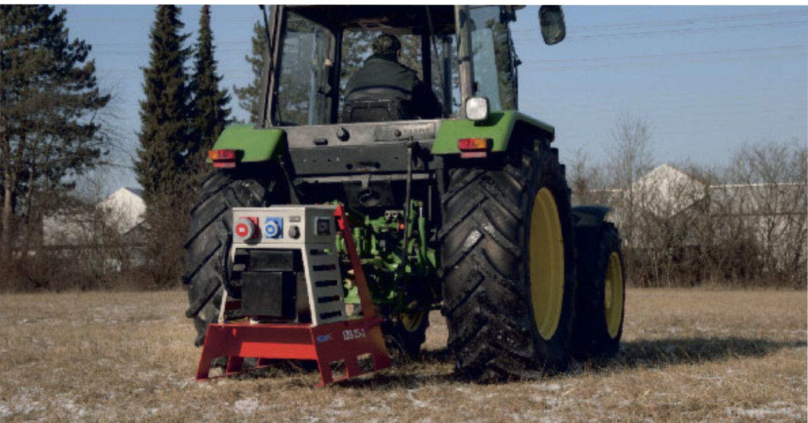
**Les générateurs pour prise de force ENDRESS proposent une alimentation électrique avantageuse. Ils sont simplement attelés aux tracteurs agricoles, il ne faut pas investir dans un moteur d'entraînement supplémentaire**
