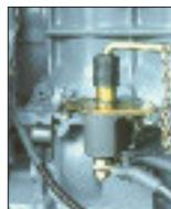
**L'interrupteur principal de la batterie** sépare la batterie de tous les composants du groupe électrogène
