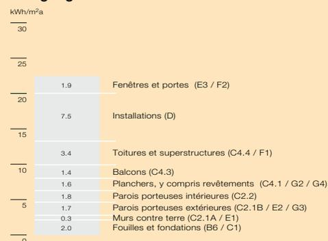
Exemple illustrant l'estimation de l'énergie grise par parties d'ouvrage.
