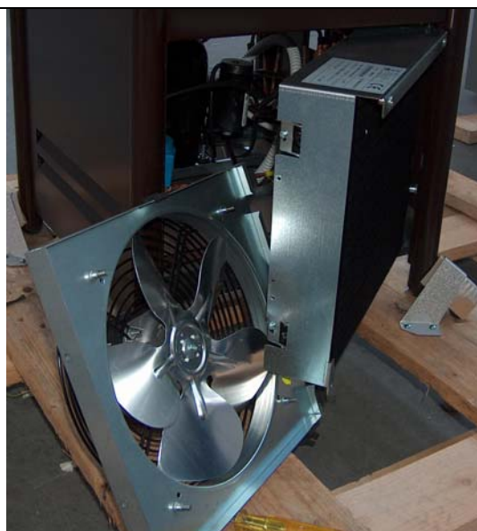
Fig. 6: débrancher le connecteur d'alimentation du ventilateur
