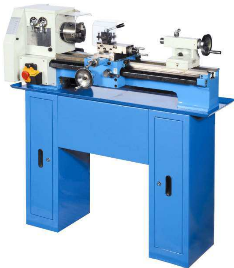
TOUR D'ETABLI DE PRECISION A ENGRENAGE 500 mm MODELE OT282500
