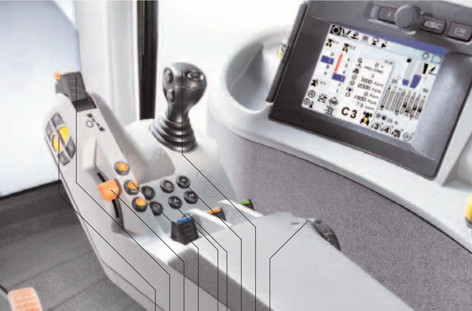
Commande du relevage arrière et gestion des fourrières CSM
