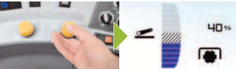
Paramétrage via CEBIS de la hauteur de relevage déclenchant le désengagement automatique de la prise de force.
