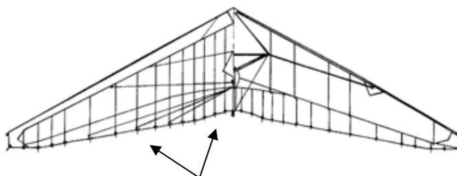
**Flappements** : l'apparition à haute vitesse d'une vibration des bords de fuite en bouts d'aile est la conséquence d'une tension insuffisante des cordelettes de tenue de ces lattes.
