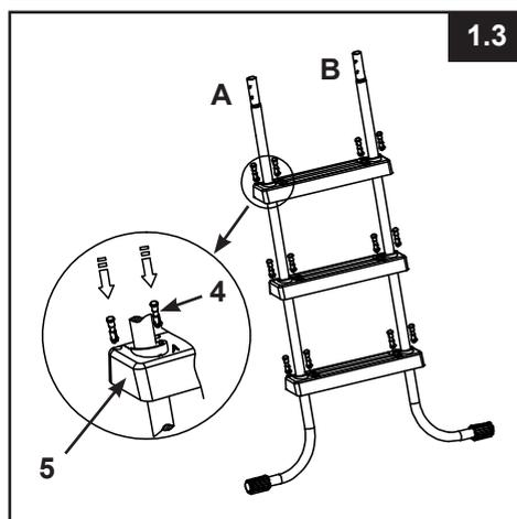
Insérez les goupilles (4) dans les trous liant la marche à la fixation du montant.
