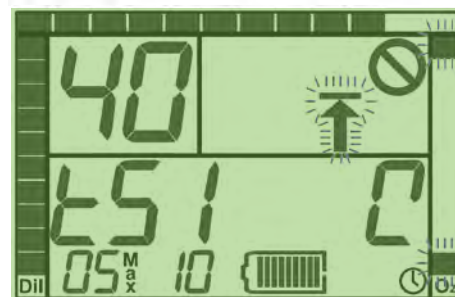
Figure A2-3 : Écrans de confirmation de l'hélium pendant le test 51 montrant les valeurs de « HE » (pour « Hélium »; en haut), « Pa » (pour « Part »; au milieu), et la valeur numérique (indiquant la part supposée d'hélium ; en bas) pour le mélange diluant.
