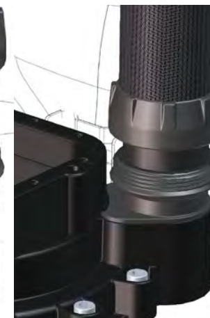
Figure 1-23. Poussez le connecteur de tuyau dans l'orifice jusqu'à ce que le collet extérieur butte contre l'extrémité du filetage.
