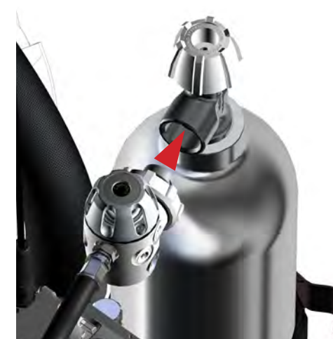
Figure 1-34. Alignez le détendeur d'oxygène avec le filetage DIN femelle de la bouteille d'oxygène. Poussez-le vers l'intérieur et serrez à la main l'écrou tournant du détendeur d'oxygène.
