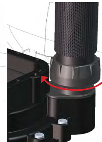
Figure 1-24. Serrez à la main la bague de serrage : N'utilisez AUCUN outil et ne serrez pas trop.
