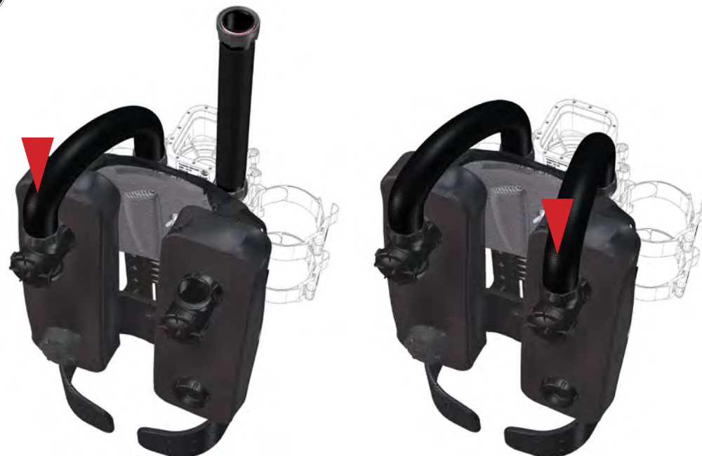
Figure 1-25. Fixez la tubulure piège à eau du contre poumon droit sur le tuyau respiratoire arrière droit.
