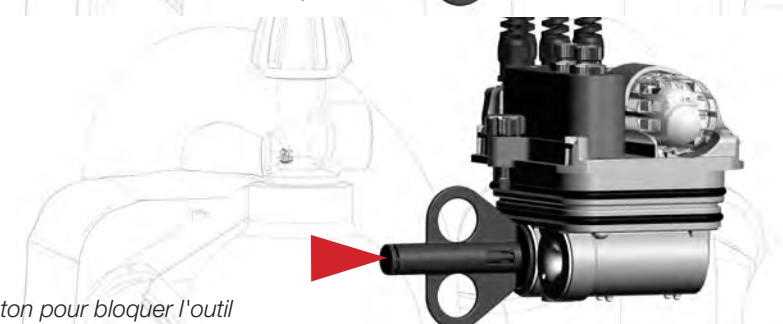
Figure 4-2. Outil de démontage enfoncé dans le socle du capteur.
