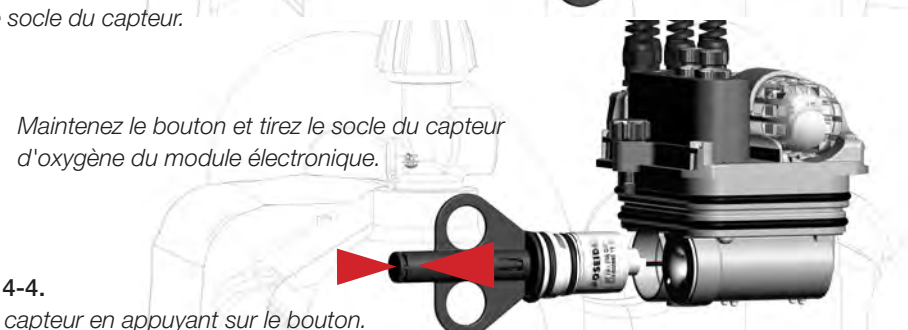
Figure 4-3. Appuyez sur le bouton pour bloquer l'outil dans le socle du capteur.
