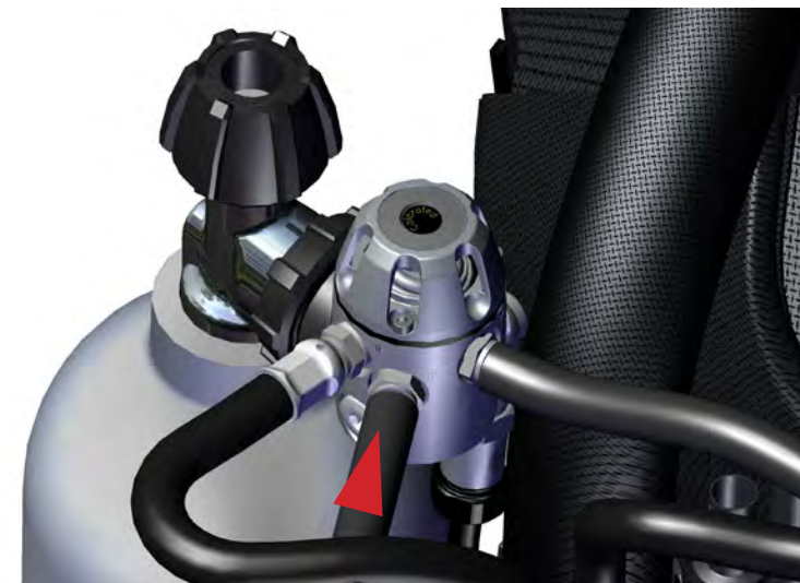
Figure 1-41. Branchez le tuyau basse pression de la source d'air alternative à un orifice basse pression (portant la marque « IP ») sur le 1er étage de diluant (volant de robinet noir).
