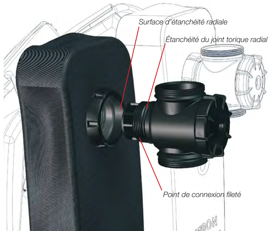
Figure 1-17. Insérer la tubulure piège à eau droite dans l'orifice du contre poumon droit.
