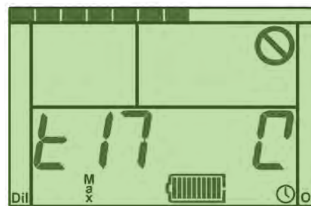
Figure A1-1 : Test 17 (consommation électrique du rétro-éclairage) affichant le numéro de test sur la gauche et la « roue tournante » sur la droite.
