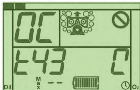
Figure 2-7. Test 43 (embout en position OC), affichant l'icône de circuit ouvert pour indiquer que l'embout doit être placé en position circuit ouvert.
