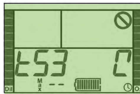
Figure 2-11. Test 53 – Étalonnage des capteurs d'oxygène.
