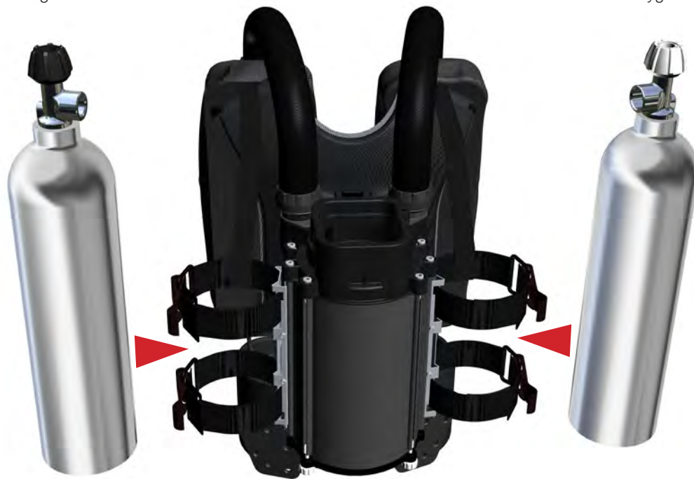
Figure 1-27. La bouteille de diluant (volant de robinet noir) est montée du côté gauche de l'appareil et la bouteille d'oxygène (volant de robinet blanc) est montée du côté droit de l'appareil.
