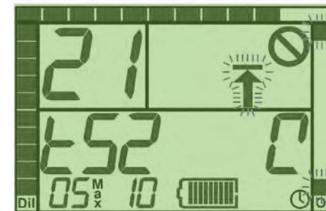
Figure A2-4 : Écrans de confirmation de l'oxygène pendant le test 52 montrant les valeurs de « O2 » (pour « Oxygène »; en haut), « Pa » (pour « Part »; au milieu), et la valeur numérique (indiquant la part supposée d'oxygène ; en bas) pour le mélange diluant.
