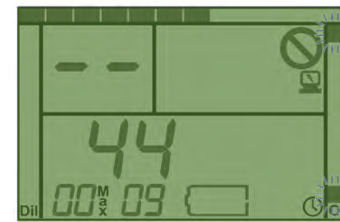
Figure 2-3. Lorsque les segments supérieurs et inférieurs de l'affichage commencent à clignoter, rebranchez les contacts humides.
