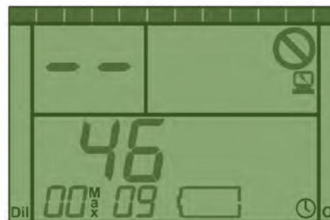
Figure 2-2. Affichages initiaux pendant les deux premières secondes de la mise sous tension, montrant la version du microprogramme et le numéro de série.
