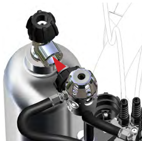
Figure 1-33. Alignez le détendeur de diluant avec le filetage DIN femelle de la bouteille de diluant. Poussez-le vers l'intérieur et serrez à la main l'écrou tournant du détendeur de diluant.
