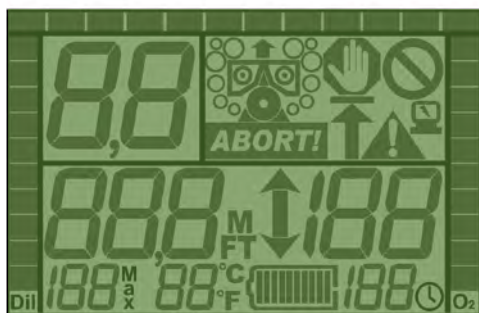
Figure 2-4. Console principale montrant tous les éléments du LCD.
