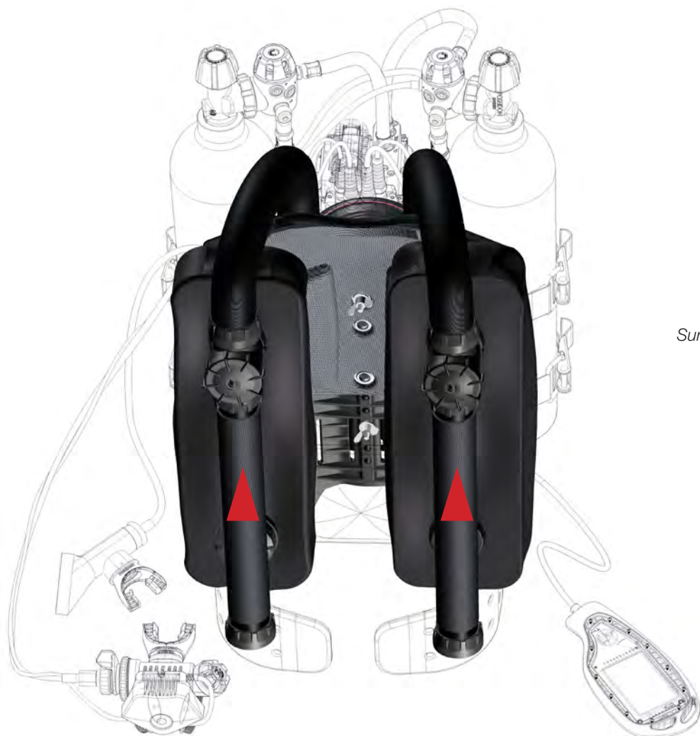
Figure 1-42. Tuyaux de respiration correctement branchés sur les pièges à eau.
