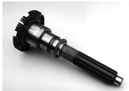
Fig 19 : Couplemètre intégré à une boîte à vitesse, l'émetteur fait 6 mm d'épaisseur, 50,5 de diamètre interne et 68 de diamètre externe.
