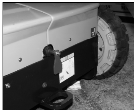
Fig. 6.2 - Levier de débrayage.
