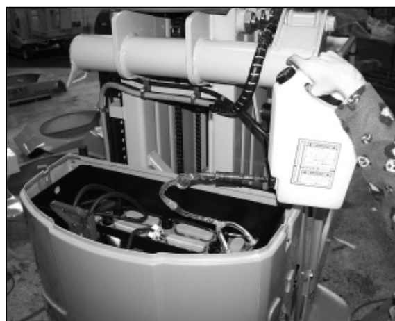
Fig 5.9. - Remplissage éléments de batterie
