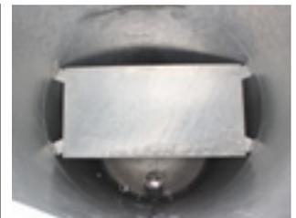
Cloison intérieure brise lame
