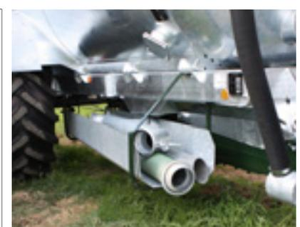
Support tuyaux sous châssis
