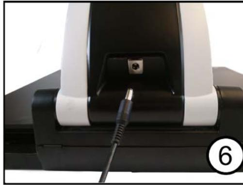
6. Raccordez l'adaptateur secteur à l'arrière de l'appareil et à la prise murale. L'appareil est prêt à être utilisé.
