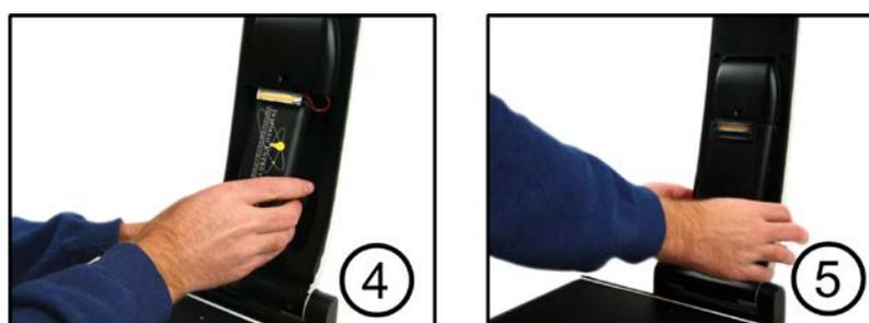
4. Tournez le bras de l'appareil de manière à pouvoir accéder aisément au compartiment de la batterie. Placez la batterie dans le contact au-dessus du compartiment à batterie.
