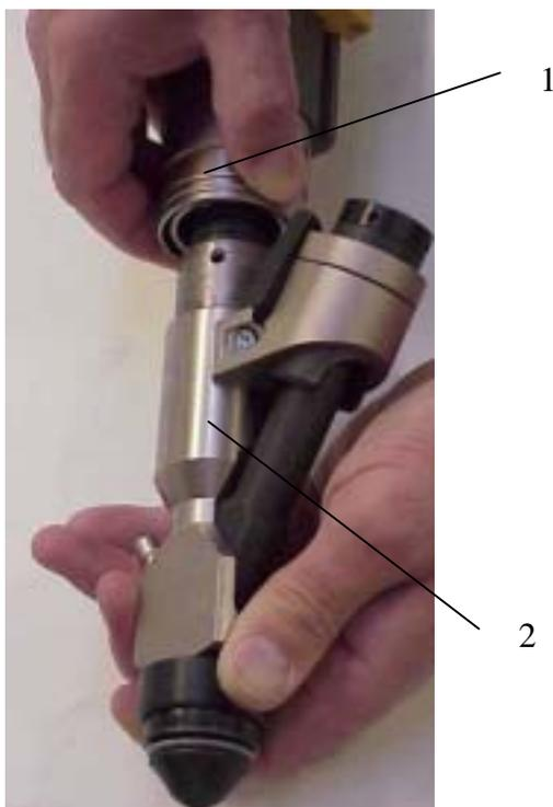
Tirer la douille à raccord rapide (1) vers le bas.
