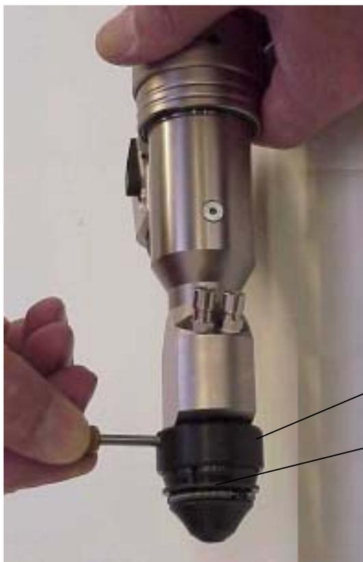
Desserrer la douille raccord (2) à l'aide de la clé à ergot, puis dévisser la mâchoire (1) .
