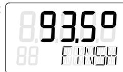
La valeur supérieure indique l'angle de rotation total du servomoteur (par exemple 93,5°).
