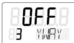
Ce paramètre ne doit être réglé que si vous désirez afficher la course totale mm en fin de phase initialisation. Sélectionner ensuite à l'écran la même valeur que celle réglée sur la graduation du levier pour la tige d'entraînement, ou la prochaine graduation supérieure pour interposition.
