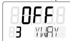
Il n'est nécessaire de régler ce paramètre qu'au cas où vous désirez, à la fin de la phase d'initialisation, obtenir l'affichage en mm de la valeur totale de la course calculée. Pour cela, choisissez sur l'afficheur une valeur égale à celle du réglage de la broche d'entraînement, sur l'échelle du levier.
