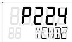
Amener le servomoteur à l'aide des touches d'incrémentatation(+) et de décrémentation(-) dans la position que vous désirez définir en tant que seconde position de butée. Appuyer ensuite sur la touche de mode de fonctionnement
