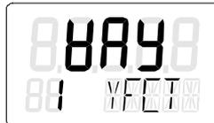
3. Régler le paramètre YFCT sur "turn" au moyen de la touche de décrémentation (-).
