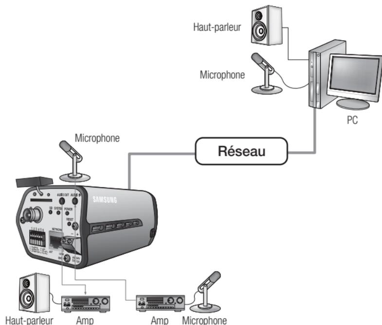
1. Connecter le port AUDIO IN de la caméra avec le microphone directement ou le port SORTIE DE LIGNE de l'amplificateur auquel le microphone est connecté.
