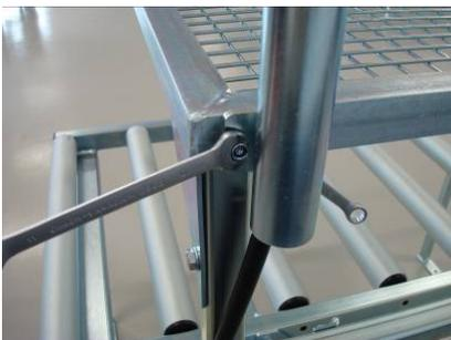
Utilisez aussi le boulon placé à l'extrémité du cadre du portique pour le montage de la suspension à ressort.
