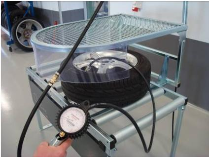
Montez le raccord de gonflage sur la valve de la roue et faire rouler la roue pour l'amener sous le portique.
