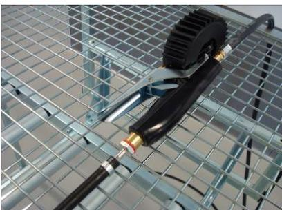
Montez le tuyau sur le manomètre de gonflage. (29)
