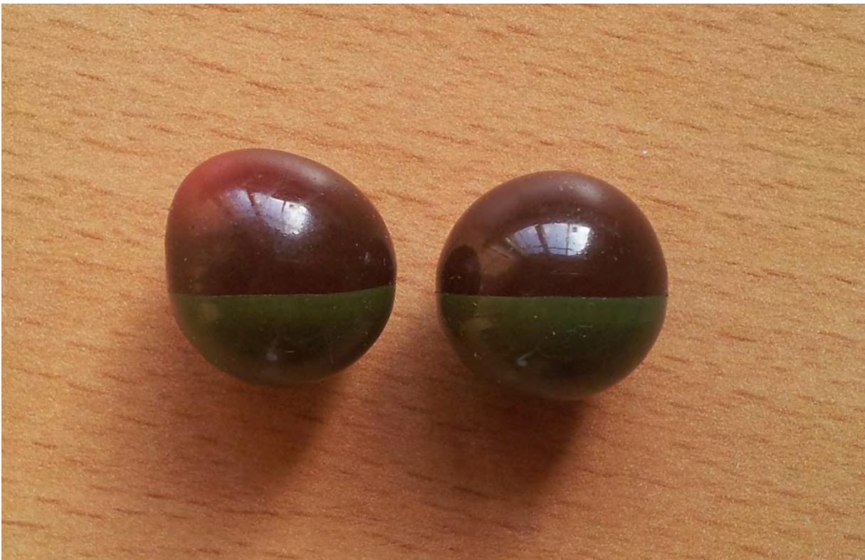
3.1.1.2 a Deux balles de paintball (celle de gauche est dilatée, celle de droite normale)
