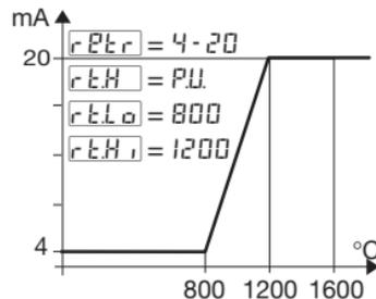
Avec le paramètre **rEtLo** supérieur à **rEtHi**, on obtient une échelle inverse.
