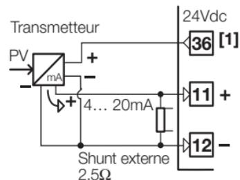
[1] Alimentation auxiliaire pour transmetteur externe 24Vdc  $\pm 20\%$ /30mA max sans protection contre les courts-circuits
