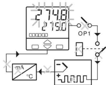
Avec **OFF**, l'alarme est de type **rupture capteur simple avec action immédiate**
