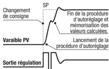
Ce mode est sélectionné quand au lancement de la procédure, la mesure est éloignée de la consigne de plus de 5% de l'échelle.
