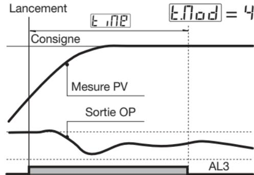
[1] Lorsque le timer n'est pas en cours, la sortie est forcée à 0. Il en est de même avant le lancement.
