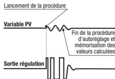
Ce mode est sélectionné quand au lancement, la mesure est proche de la consigne. Elle présente l'avantage d'une meilleure précision du calcul dans une durée raisonnable.
