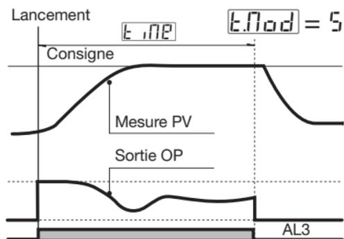
[1] Lorsque le timer n'est pas en cours, la sortie régulation est forcée à 0. Il en est de même avant le lancement.
