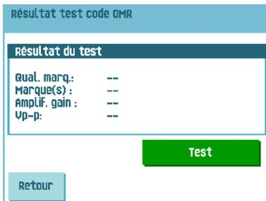
2. Appuyez sur le bouton **[Test]** pour lancer le test OMR. Le test terminé, l'écran Résultat apparaît.
