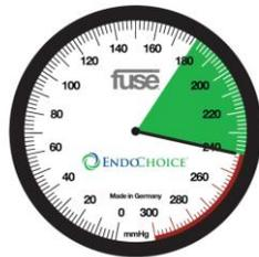
2. Observer le cadran du testeur d'étanchéité avec attention pendant au moins 30 secondes tout en changeant l'angle de la section de béquillage. Vérifier que la pression ne descend pas. L'absence de chute de pression signifie que l'appareil ne présente pas de fuite et qu'un test d'étanchéité en immersion (sous l'eau) peut être effectué en suivant.
