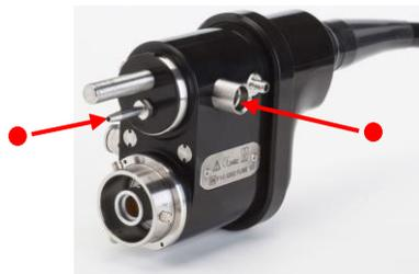
3. Déboucher les entrées d'air/eau sur le côté du connecteur principal et rincer lentement les canaux d'air/eau avec 90 ml de désinfectant au minimum.
