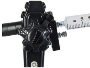
2. Boucher l'entrée d'aspiration sur le côté du connecteur principal avec un doigt ganté et boucher également le canal de travail ; à l'aide d'une seringue, faire circuler lentement un minimum de 90 ml d'air à travers le canal d'aspiration.
