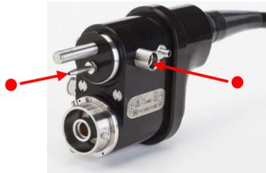
3. Déboucher les entrées d'air/eau sur le côté du connecteur principal et faire circuler lentement un minimum de 90 ml d'air à travers les canaux d'air/eau.
