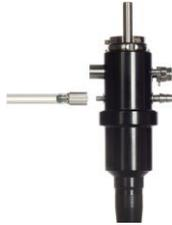
2. Raccorder une seringue remplie de détergent à l'adaptateur de nettoyage pour le port d'approvisionnement en eau auxiliaire, et rincer lentement le canal d'eau auxiliaire avec 90 ml de détergent.
