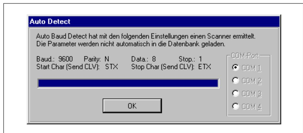
Fig. 10-23 : CLV-Setup : Fenêtre de résultat de la détection automatique.
