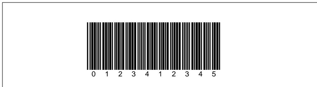
Fig. 6-1 : Modèle de code à barres (Code 39 ; 0,35 mm ; contraste d'impression 2:1)
