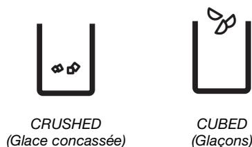
Pour de la glace concassée, les glaçons sont concassés avant d'être distribués. Cette action peut causer un court délai lors de la distribution de glace concassée. Le bruit du broyeur de glaçons est normal et la dimension des morceaux de glace peut varier. Lorsqu'on passe du mode glace concassée au mode glaçons, quelques onces de glace concassée sont distribuées avec les premiers glaçons.
