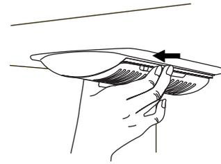
3. Remplacer la ou les ampoule(s) grillée(s) avec une (ou des) pour appareil ménager ne dépassant pas 40 watts.
