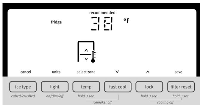
**REMARQUE :** Pour visualiser les températures en Celsius, appuyer sur la touche LIGHT (éclairage) lorsque le mode de réglage est activé. Pour revenir au mode d'affichage en Fahrenheit, appuyer de nouveau sur LIGHT.
