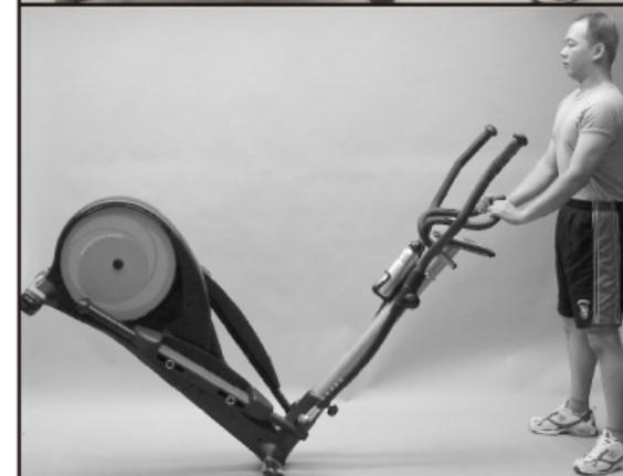
1. Déplacez l'avant de l'appareil et vérifiez que les BRAS A DOUBLE ACTION (007 & 008) soient parallèles à une Pédale se trouvant en haut du COUVERCLE DE ROUE et l'autre en bas;
