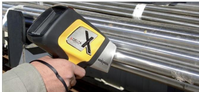
Le puissant appareil XRF portable DELTA optimise la vitesse et la précision d'analyse des alliages et des métaux, ainsi que les opérations de QA/QC, de sûreté ou d'entretien.
