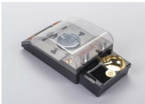
5. La balance Accu-Touch 2000 est équipée d'un casier de rangement pour les accessoires fournis avec la balance. Ce casier se trouve sur la face arrière de la balance. En appuyant, puis en relâchant, le dispositif d'arrêt se débloque et le casier peut être retiré de la balance. La coupelle et les composants de l'égreneur à poudre se trouvent là-dedans (voir la photo).
